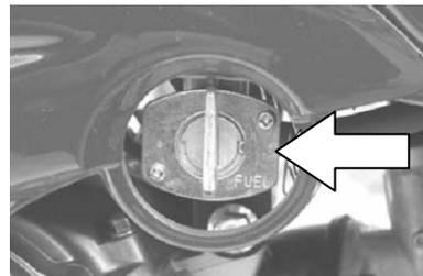
рисунке, или поверните рычаг на отметку «RESERVE», чтобы обеспечить подачу резервных 1, 6 литра бензина из бака.
