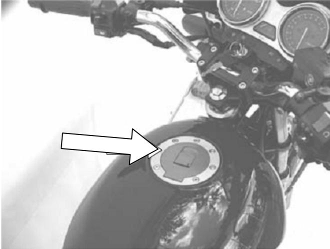
Чтобы закрыть крышку, выровняйте ключ по стрелке и подтолкните его вниз, пока не услышите щелчок. Это означает, что бак закрыт. Выньте ключ.
