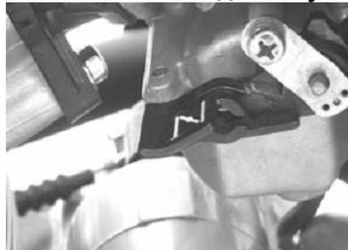
Если двигатель холодный (до 35°C) требуется воспользоваться системой холодного пуска. Карбюратор оборудован заслонкой и рычагом управления заслонкой для
