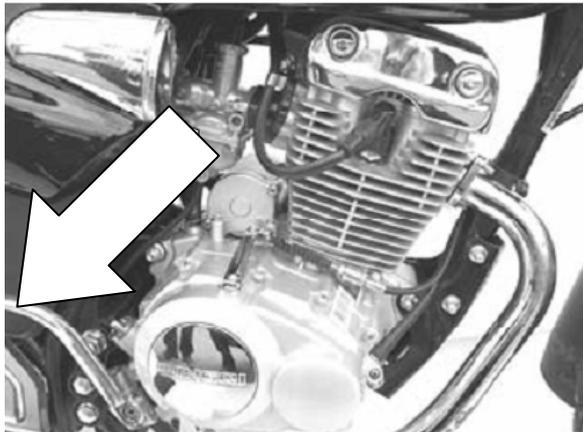
Мотоцикл оборудован рычагом кик-стартера, который распложен с правой стороны двигателя.
