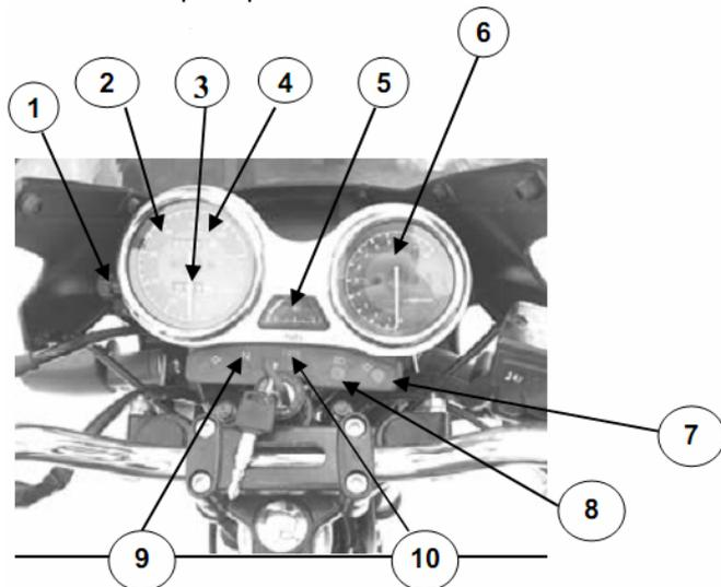
1. Кнопка сброса – обнуляет показание дополнительного одометра.
